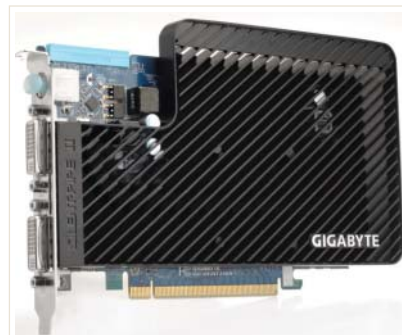
GIGABYTE RADEON HD2600XT: Výhodou může být i naprostě tiché chlazení. Nejvýkonnějším Radeonem s pasivním chlazením je HD3850.
